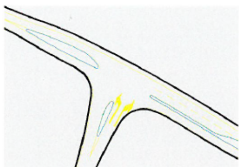
Figur 1 viser kjøremønster fra ny hovedveg om morgenen for T-kryss.
